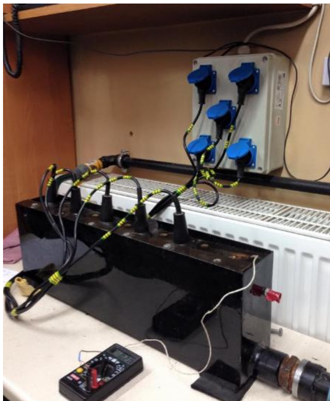
Rys. 1. Zestaw do pomiaru mocy grzewczej grzałek
